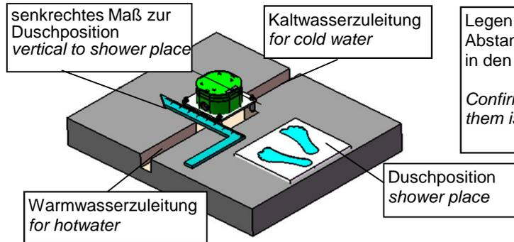
Legen Sie die Position der Montagebox fest. Beachten Sie bitte den Abstand zur Duschposition von 750 mm. Danach wird die Montagebox in den Boden eingebracht (bitte entsprechendes Loch vorbereiten)
