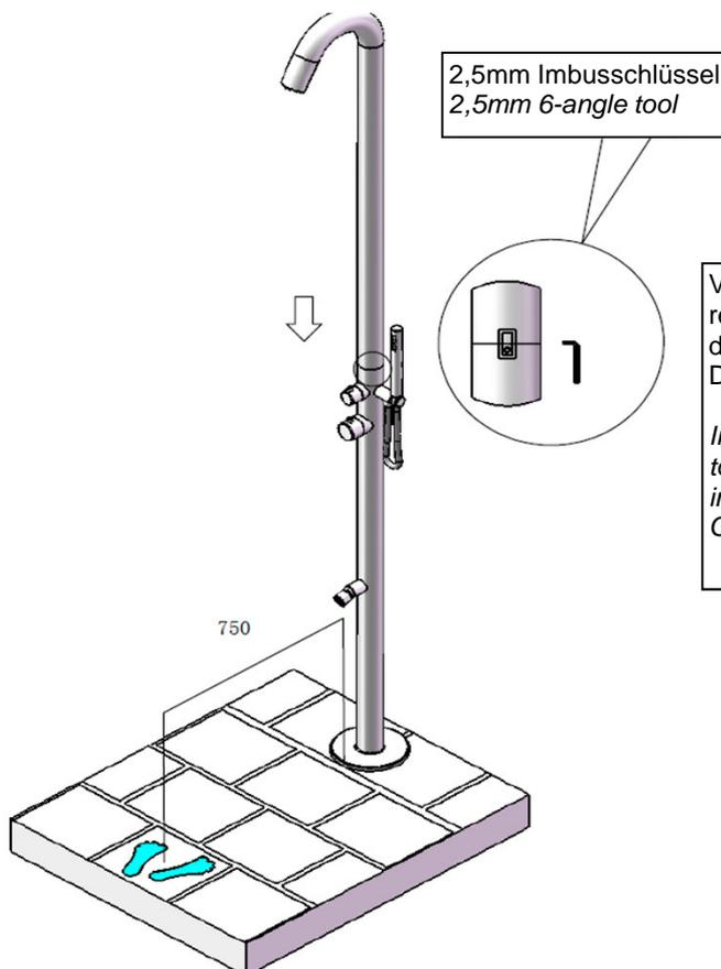
Verbinden Sie das Oberteil der Dusche mit dem Unterteil. Eine rechteckige Markierung hilft Ihnen bei der Ausrichtung. Fixieren Sie danach das Ober- und Unterteil der Dusche mit der Madenschraube. Danach schließen Sie die Handbrause an (falls vorhanden)
